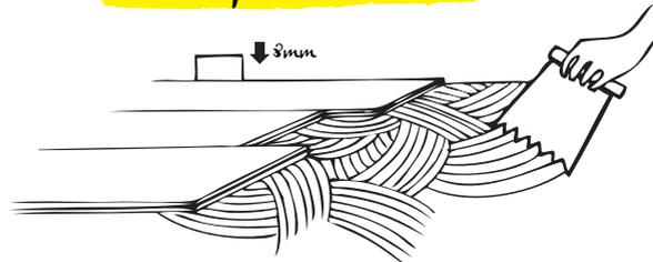
Etaler la colle sur le sol à l'aide de la spatule. Encoller uniquement la surface équivalente à quelques lames, la quantité idéale de colle étant de 800g à 1000g de colle par m<sup>2</sup>.
