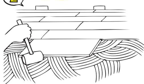
Insérer chaque lame de parquet dans la précédente en utilisant un maillet et une pièce en bois de façon à ne pas endommager les bords des lames.
